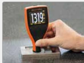
3. 当完全固化后，在CCM的侧面校准铁基涂层测厚仪，然后进行测量，并在该涂层的中心记录干膜厚度。
