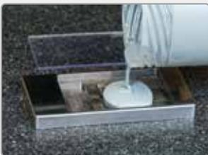
1. 放置涂层校准模具在平坦表面上并完全用测试涂料填充样品室。
