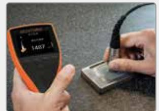
4. 使用Elcometer 500测量相同点。
