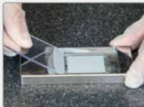
2. 使用塑料刮板，刮过涂料允许过量涂料落入溢流室。允许该涂层变干。
